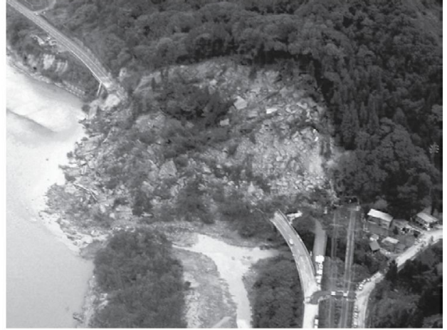
شكل (6): تساقط وتدحرج القطع الصخرية في المناطق الجبلية المنحدرة بسبب تعرض هذه المناطق للهزات الأرضية
